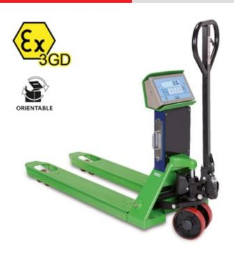
ATEX-Gabelhubwaage für den Einsatz in explosionsgefährdeten Bereichen (ZONE 2 und 22) in den Schutzarten Ex II 3G IIC T6 Gc X und Ex II 3D IIIC T115C° Dc X.
